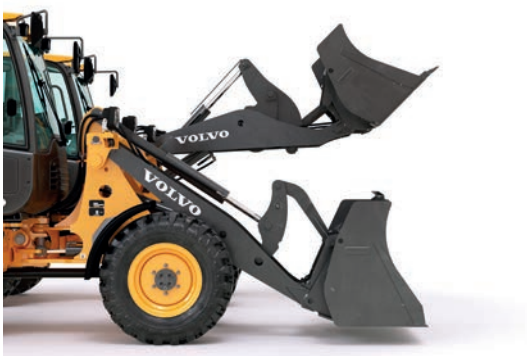
平行またはZバーリンケージを選択可能 (L25エレクトリック)
