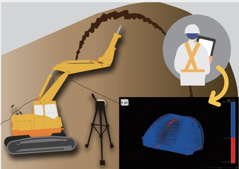
従来作業員が切羽まで近付いて目視確認をしていたところを、本アプリを使用して、設計データと計測データの差異分(当り)が表示されるモニターを確認しながら、安全にコソク作業が実施できます。
