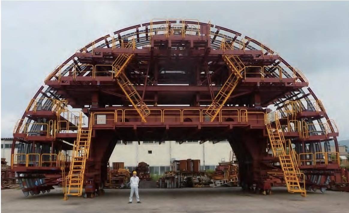
拡幅断面用移動セントル
