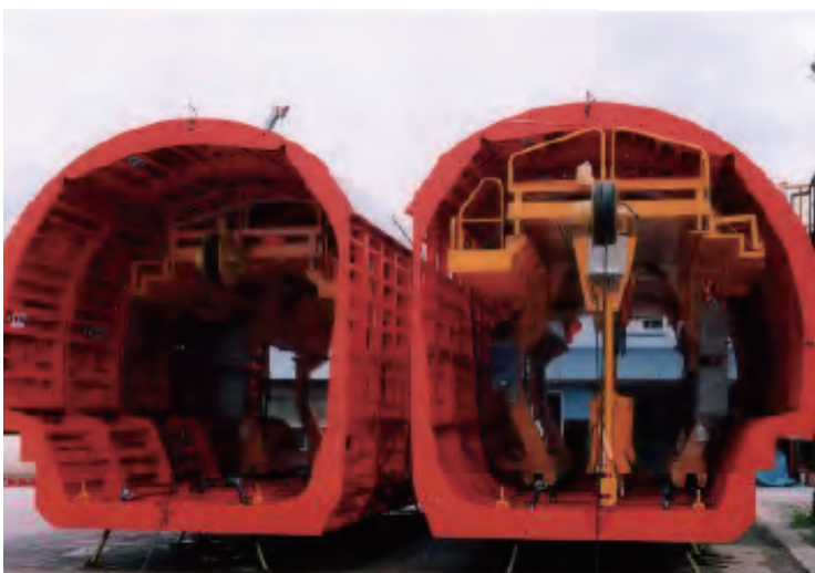
DOT 工法用テレフォーム (名古屋地下鉄)
