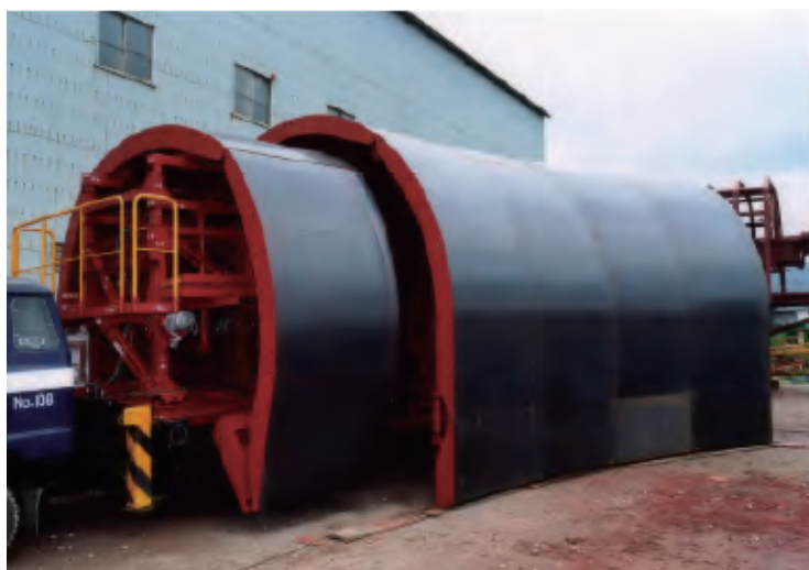
山岳用テレスコピック型枠 (タイヤ移動方式)
