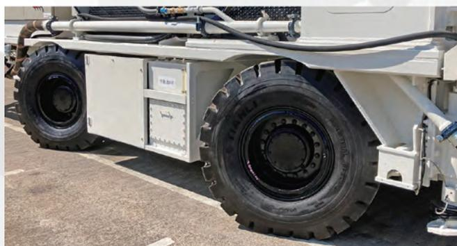
ベースマシンには国交省指定第 3 次基準値排出ガス対策型エンジン **C6.6 ACERT** を搭載しています。全輪駆動にてスピーディーかつパワフルな走行性能を発揮します。
